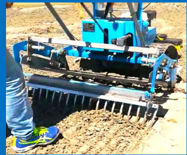
Heckrechen (Option) lockert Hackschnitzel und Rindenmulch
