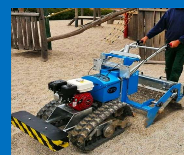
Reinigt Kies- und Rieselflächen, entfernt Unrat und die Lehmschicht unter der Oberfläche.
